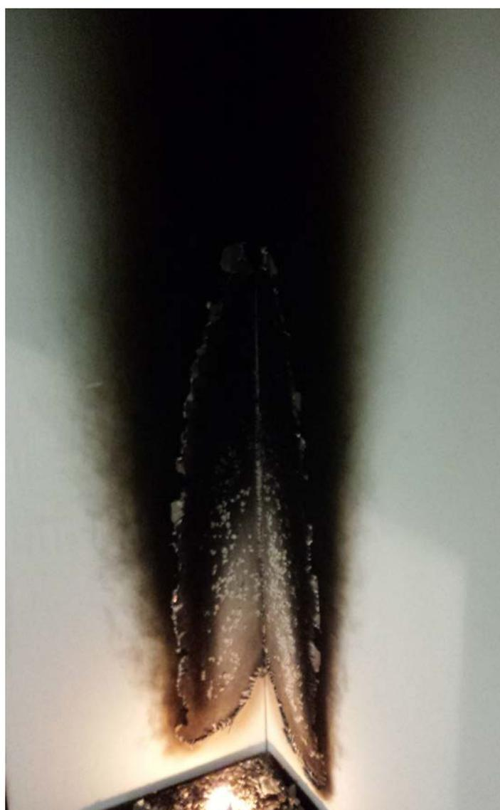
**Aspecto de la muestra tras el ensayo de SBI
